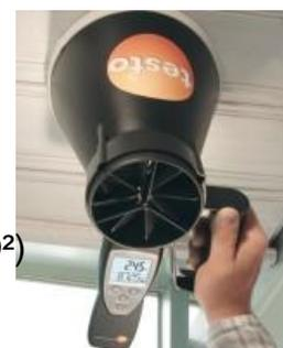
Lufttechnische Messungen (Volumenstrom, Temperatur, Feuchtigkeit, CO<sub>2</sub>)
